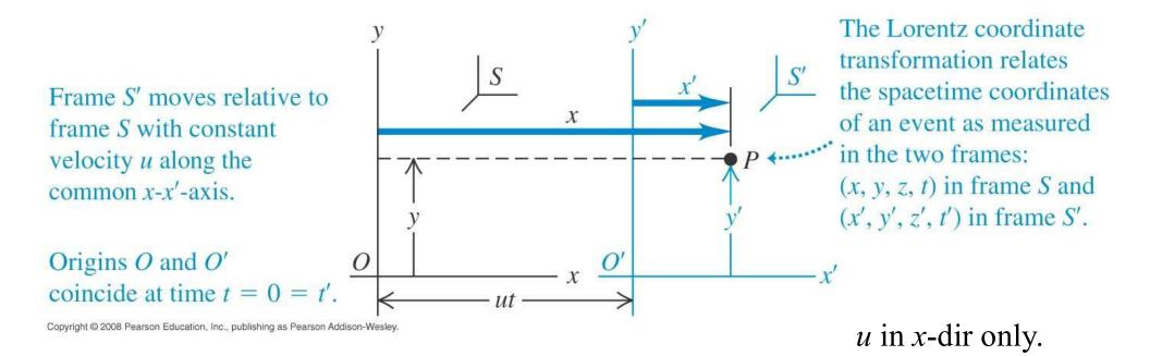
$(x, y, z, t) \quad \longleftrightarrow \quad (x', y', z', t')$
