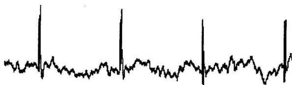
Figura 4. Señal típica adquirida, sin promedio sincrónico.
