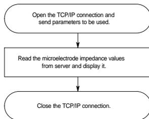
**Fig. 6: Flowchart of the VI “Platinização e Medida de Impedância - Cliente.vi”.**
