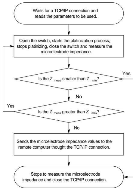
**Fig. 5: Flowchart of the VI “Platinização e Medida de Impedância - Servidor.vi”.**
